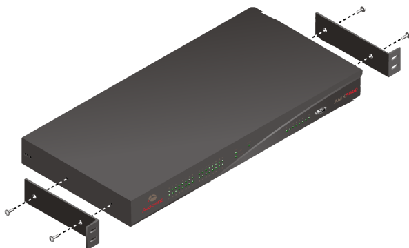
Figure 2.4 : Schéma de montage en rack du commutateur AMX5000
