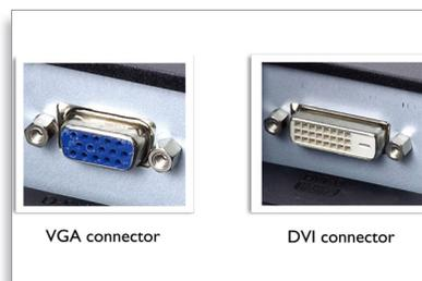
La double entrée prévoit des connecteurs permettant l'entrée de signaux analogiques VGA et de signaux numériques DVI.
