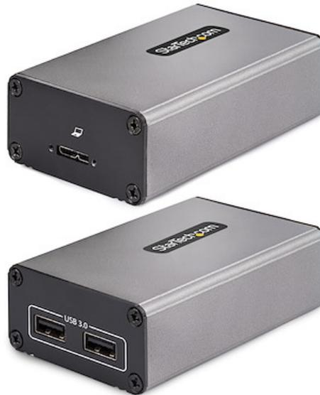
Avec ce prolongateur USB sur fibre multimode haute performance, vous pouvez étendre les signaux USB 3.2 Gen 1 à 5 Gbps sur un câble en fibre OM3 LC à LC avec une portée allant jusqu'à 350m.
