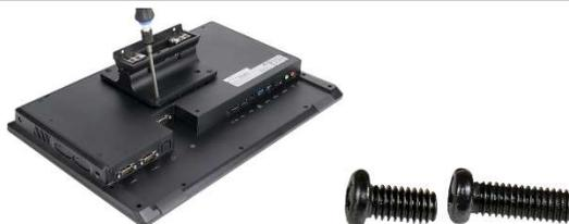
3. Setzen Sie den PC/Monitor mit montiertem VESA-Halter auf den Standfuß und fixieren ihn mit zwei Senkkopf-Schrauben.
