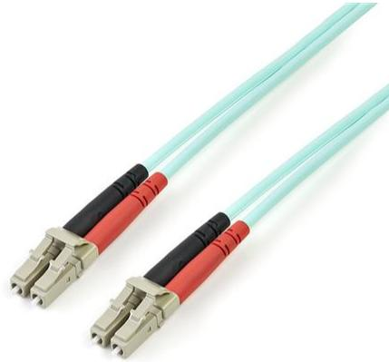
El Cable Patch de Fibra LSZH Duplex Multimodo Aqua 50/125, 10 Gigabit de 2m (6,6 pies), A50FBLCLC2, dispone de conectores LC (machos) en ambos extremos y está compuesto por fibra aqua OM3 de 50/125 micrones para proporcionar transferencias de datos confiables a velocidades vertiginosas, siendo ideal para el tendido de cables de fibra entre múltiples conmutadores troncales, concentradores, routers y equipos de red de alta gama.
