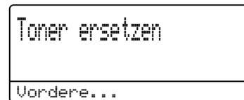
Das Gerät stoppt den Druckvorgang, bis Sie die Tonerkassette ausgetauscht haben. Das Einsetzen einer neuen Brother Original-Tonerkassette behebt den Toner-ersetzen-Fehler.
