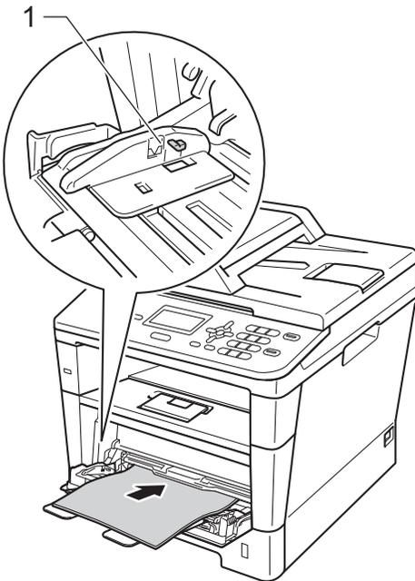
4 Klappen Sie die Papierstütze des Papierausgabefaches hoch, damit das Papier nicht aus dem Ausgabeschacht für Druckseite nach unten rutscht, oder nehmen Sie jede Seite sofort nachdem sie ausgegeben wurde aus dem Gerät.
