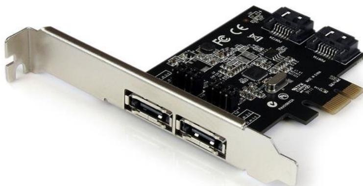
La scheda controller PCI Express SATA III (6 Gbps) PEXESAT322I offre la possibilità di aggiungere 2 porte SATA interne o esterne al computer tramite un unico slot per schede PCI Express (x1). La scheda presenta la selezione jumper integrata che permette di configurare la scheda in modo da fornire 2 porte SATA III interne ed esterne o una di ogni secondo la necessità.
