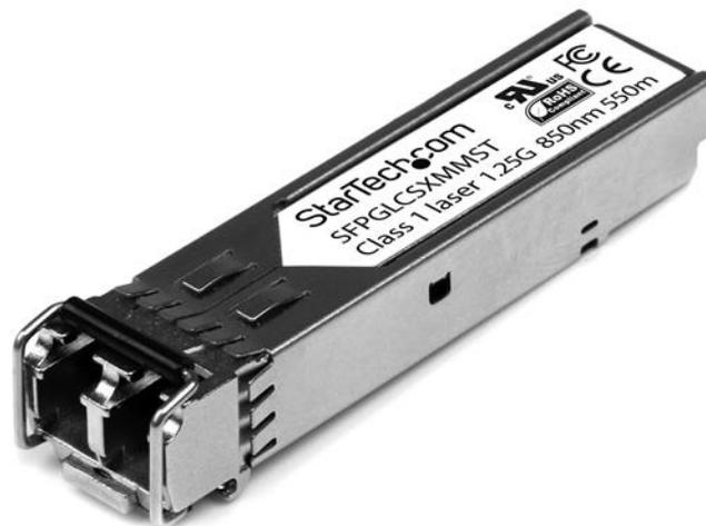
Das SFPGLCSXMMST ist ein Cisco GLC-SX-MM-kompatibles Glasfaser-Transceiver-Modul, das speziell für die Zusammenarbeit mit Cisco®-Switches und -Routern entwickelt, programmiert und getestet wurde. Es liefert zuverlässige 1-GbE-Konnektivität (1000 Mbit/s) über Glasfaserkabel für 1000BASE-SX-konforme Netzwerke mit einer maximalen Entfernung von bis zu 550 m.
