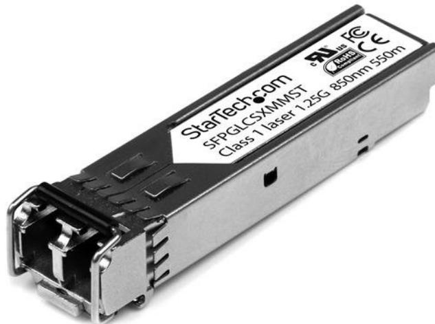
Il prodotto SFPGLCSXMMST è un modulo ricetrasmittitore per fibra compatibile con Cisco GLC-SX-MM, progettato, programmato e testato per operare con switch e router a marchio Cisco®. Offre un'affidabile connettività da 1 GbE (1000 Mbps) tramite cavo in fibra per le reti compatibili con 1000BASE-SX, a una distanza massima di 550 m.
