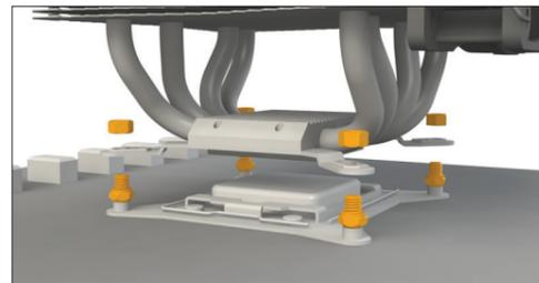
Setzen Sie die Sechskant-Muttern (8) auf die Distanzmuttern (7) und ziehen Sie diese mit Hilfe des Maulschlüssels (14) kreuzweise handfest an.
