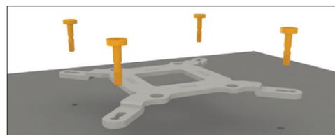
Über die Mainboard-Vorderseite fixieren Sie die Backplate indem Sie die C-Profil Distanzhalter (12) auf die Einkerbung der M3x16 Schrauben (9) drücken, bis diese einrasten.
