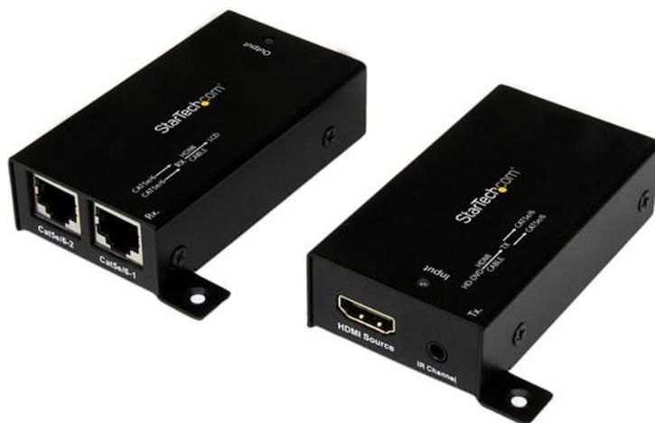
Cet extenseur HDMI® sur câble double CAT5 transmet vos signaux A/V HDMI avec IR à un emplacement jusqu'à 30 m de distance sur des câbles doubles CAT5/CAT6.
