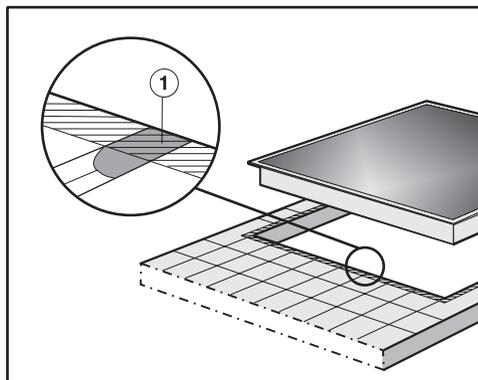
Le fessure ① e l'area tratteggiata sotto la superficie d'appoggio del piano di cottura devono essere lisce e perfettamente in piano affinché il piano poggi uniformemente e la guarnizione applicata sotto il bordo della parte superiore dell'apparecchio possa garantire una tenuta sufficiente verso il piano di lavoro.
