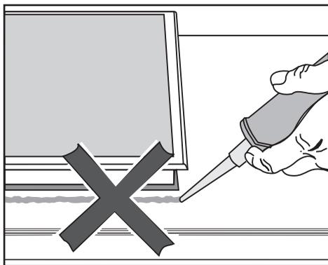
Il nastro di guarnizione sotto il bordo della parte superiore dell'apparecchio garantisce la sufficiente tenuta al piano di lavoro.
