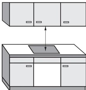
Se il piano di cottura viene installato sotto una cappa aspirante, è necessario rispettare la distanza di sicurezza indicata dal produttore della cappa.
