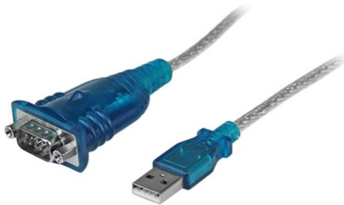
L'adattatore USB a seriale a 1 porta ICUSB232V2 permette di convertire una porta USB in una porta seriale RS232 DB9 per collegare, monitorare e controllare un dispositivo seriale.
