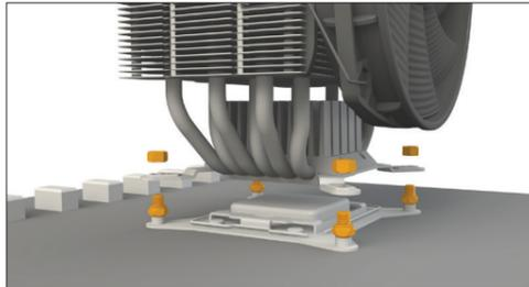
Setzen Sie die Sechskant-Muttern (8) auf die Distanzmuttern (7) und ziehen Sie diese mit Hilfe des Maulschlüssels (13) kreuzweise handfest an.
