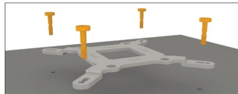
Über die Mainboard-Vorderseite fixieren Sie die Backplate indem Sie die C-Profil Distanzhalter (11) auf die Einkerbung der M3x16 Schrauben (9) drücken, bis diese einrasten.
