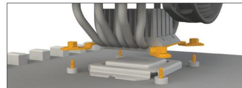
von der Rückseite des Mainboards mit den an dem Kühler befestigten Sechskantmuttern mit Hülse (6) verschrauben lassen.
