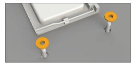
Über die Mainboard-Vorderseite fixieren Sie die Backplate indem Sie die C-Profil Distanzhalter (11) auf die Einkerbung der M3x16 Schrauben (9) drücken, bis diese einrasten.
