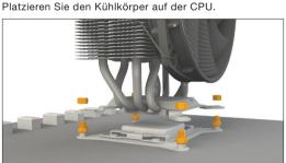
Setzen Sie die Sechskant-Muttern (8) auf die Distanzmuttern (7) und ziehen Sie diese mit Hilfe des Maulschlüssels (13) kreuzweise handfest an.
