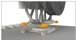
dass sich die M3x16 Schrauben (9) von der Rückseite des Mainboards mit den an dem Kühler befestigten langen AMD Montagebrücken (5) verschrauben lassen.
