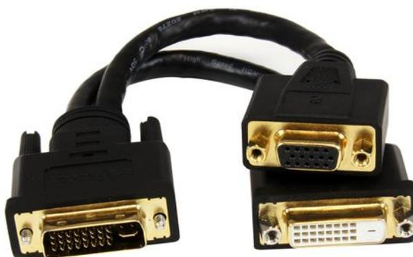
Le câble répartiteur Wyse DVI DVI92030202L est doté d'un connecteur DVI-I mâle qui se divise en un câble DVI-D femelle et en un câble HD15 VGA femelle, ce qui vous permet de brancher simultanément un écran DVI-D et un écran VGA à votre terminal Wyse.
