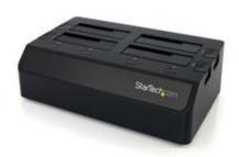
La estación de conexión (4 bahías) para disco duro SATA HDD / SSD de 2,5"/3,5", modelo SDOCK4U33, permite conectar e intercambiar, de forma simultánea, unidades de disco duro de un ordenador de sobremesa o portátil, a través de un único puerto USB.
