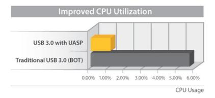
Los resultados de las pruebas se obtuvieron al utilizar un sistema Ivy Bridge de Intel®, una caja de StarTech.com con UASP disponible, así como una unidad SATA III de estado sólido (SSD).
