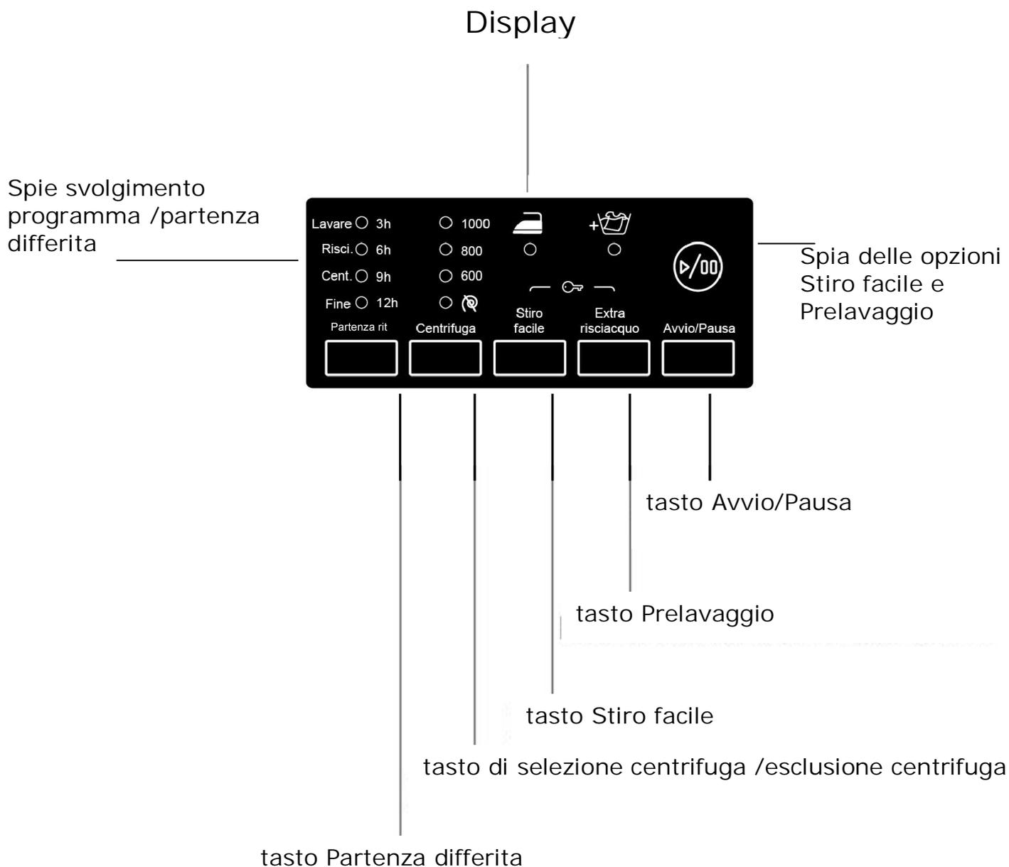
Sul display potete controllare l'impostazione della partenza differita, la regolazione della velocità di centrifuga selezionata, le opzioni selezionate e lo svolgimento del programma di lavaggio (lavaggio, risciacquo, centrifuga, fine).
