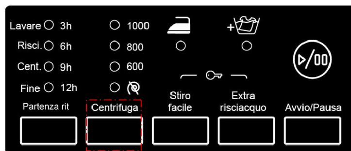
Potete progressivamente ridurre la velocità della centrifuga premendo in continuazione il tasto "Centrifuga" tra l'opzione
