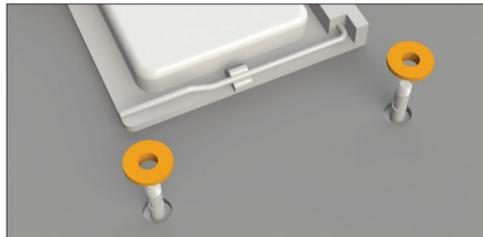
Fixez la plaque arrière sur la face avant de la carte mère en utilisant les entretoises-C (12), poussez celles-ci sur les vis M3x15 AMD (10) jusqu'à ce qu'elles se clipsent.
