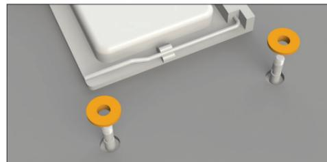
Fixez la plaque arrière en utilisant les entretoises-C (12), poussez celles-ci sur les vis M3x15 AMD (10) jusqu'à ce qu'elles se clipsent.
