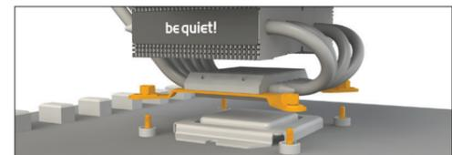
sur le côté arrière de la carte mère avec les écrous hexagonaux avec manchon (6) fixés sur le radiateur.
