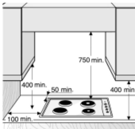
**NOTA:** Qualora venga installata una cappa sopra il piano di cottura, consultare le istruzioni di montaggio della cappa nelle quali è riportata la distanza corretta da rispettare.
