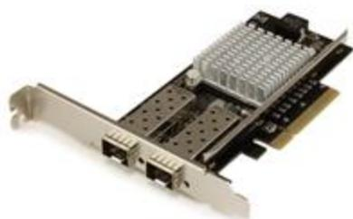
Obtenga conectividad rápida con un alto ancho de banda mediante esta económica tarjeta de red por fibra óptica. Agrega dos ranuras SFP+ abiertas a su servidor o estación de trabajo de alta potencia, lo cual constituye una forma fácil de conectar su servidor o su estación de trabajo a una red de 10 Gigabits (por fibra óptica), mediante sus módulos SFP+ preferidos.
