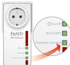
5. Drücken Sie am zweiten Powerline-Adapter den Taster für sichere Powerline-Verbindungen (Pairing-Taster).
