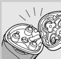
Non asciugate l'unità di rasatura con stracci o con l'asciugamano, per evitare di danneggiare le testine di rasatura.
