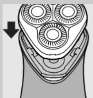
**5** Volte a colocar a unidade de corte na máquina.
