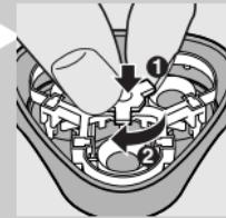
برای بهتر تمیز کردن، سرهای ریش تراش را هر شش ماه یکبار در یک مایع چربی شور (برای مثال الکل) قرار دهید. برای جدا کردن سرهای ریش تراش مراحل ۱ تا ۴ را که در بالا توضیح داده شده است دنبال کنید. بعد از تمیز کردن برای جلوگیری از فرسودگی سرهای ریش تراش قسمت مرکزی محافظتها را با یک قطره روغن چرخ چرب کنید.
