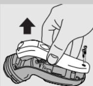
A máquina de barbear não deverá ser ligada novamente à corrente depois de lhe ser retirada a bateria.
