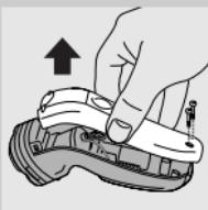
**2** Laissez l'appareil fonctionner jusqu'à l'arrêt complet du moteur, ôtez les vis et ouvrez l'appareil.
