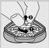
**1** Abra a unidade de corte, rode o anel para a esquerda (1) e remova a armação de retenção (2).
