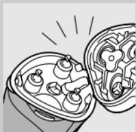
**6** Open de scheerunit opnieuw en laat hem open staan om het apparaat volledig te laten drogen.
