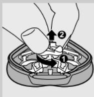
**1** Open de scheerunit, draai het wielletje linksom (1) en verwijder de opsluitplaat (2).
