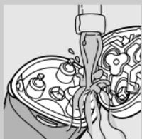
**3** Risciacquate l'unità di rasatura e la vaschetta di raccolta dei peli sotto l'acqua calda corrente.
