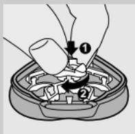
**5** Remettez la plaque de fermeture sur l'unité de rasage, pressez la molette (1) et tournez-la dans le sens des aiguilles d'une montre (2).
