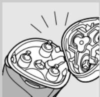
**6** Vuelva a abrir la unidad afeitadora y déjela abierta para permitir que el aparato se seque completamente.
