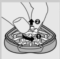
**1** Aprite l'unità di rasatura, ruotate la rotella in senso antiorario (1) e togliete il telaio di fissaggio.
