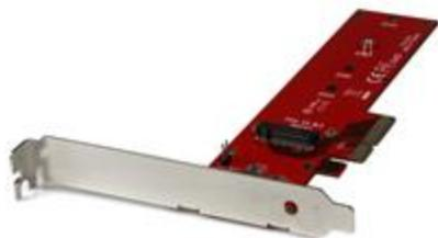
Obtenga acceso ultrarrápido a los datos agregando una unidad SSD PCIe M.2 a su ordenador existente. Este adaptador le permite agregar una unidad SSD M.2 (basado en PCIe) de alta velocidad y 4 carriles, como Samsung 950 Pro o Samsung SM 951, a un ordenador que tenga una ranura de expansión PCI Express x4 disponible. Puede instalar la unidad PCIe M.2 directamente en el adaptador, como manera fácil y práctica de mejorar el rendimiento de su sistema y de ampliar todo el almacenamiento interno.
