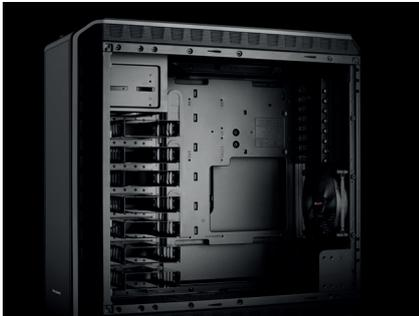
**MB-Tray:** Die Installation des Mainboard-Trays passt sich stets individuellen Raumanforderungen an: Es ist komplett höhenverstellbar, kann für einen neu definierten Luftstrom gespiegelt auf der linken Seite installiert oder vollständig entfernt werden, um als Bench-Table zu dienen.
