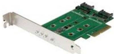
La scheda adattatore SSD M.2 a 3 porte è l'unica che supporta SSD (unità a stato solido) M.2 basati su SATA e PCIe. Soluzione versatile per l'espansione dello storage di PC o server. Inoltre, il supporto delle unità M.2 PCIe ad alta velocità ottimizza prestazioni e velocità del computer.
