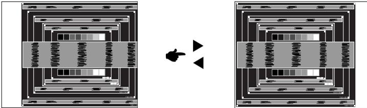
2) Etirez le côté droit de l'écran vers le bord droit de l'écran en réglant la Fréquence d'horloge.
