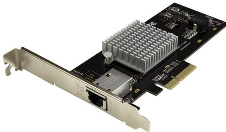
Una soluzione potente ed economica per aggiornare server o workstation a reti Ethernet 10 Gigabit con cablaggio in rame. Questa scheda di interfaccia di rete PCI Express 10G consente di aggiungere una porta Ethernet al server o al computer desktop in uso per accedere alla rete a diverse velocità: 10G, 5G, 2,5G 1G e 100 Mbps.
