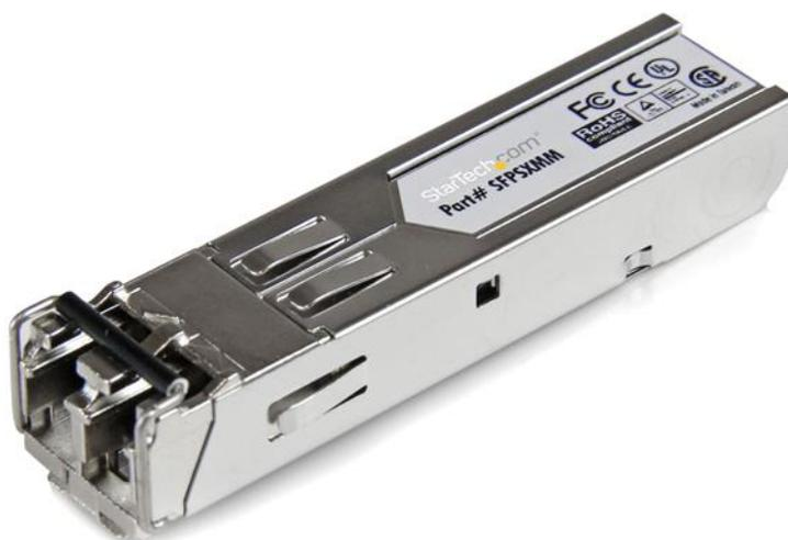
SFPSXMM è un ricetrasmittitore SFP in fibra conforme a MSA e TAA progettato, programmato e testato con switch e router MSA compatibili con 1000BASE-SX. Il modulo ricetrasmittitore SFP supporta una distanza massima fino a 550 m e offre una connettività da 10 GbE affidabile tramite cavo in fibra.
