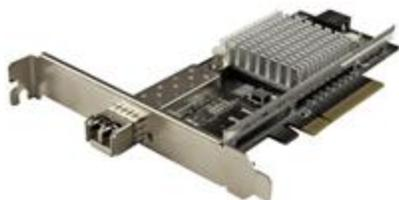
Esta tarjeta de red por fibra óptica ofrece conectividad en red fiable y de alto rendimiento, una manera sencilla y que resulta económica de actualizar su servidor o estación de trabajo a la conectividad con redes de 10 Gigabits a través de fibra óptica multimodo. La tarjeta de red 10G incluye un transceptor SFP+ multimodo instalado, con rango de hasta 330 metros, para poder empezar a funcionar rápidamente.
