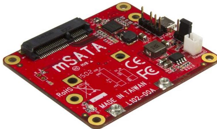
Augmentez la capacité de stockage des données de votre Raspberry Pi ou d'une autre carte de développement en la connectant directement à un disque mSATA. Idéal pour les projets et les applications personnalisés, ce convertisseur USB vers mSATA prend en charge tous les modèles de Raspberry Pi ainsi que d'autres cartes de développement.
