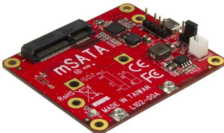
La connessione diretta a un'unità mSATA consente di aumentare la capacità di archiviazione dei dati di Raspberry Pi o di un'altra scheda di sviluppo. Ideale per la personalizzazione di progetti e applicazioni, questo convertitore USB a mSATA supporta tutti i modelli Raspberry Pi, così come altre schede di sviluppo.
