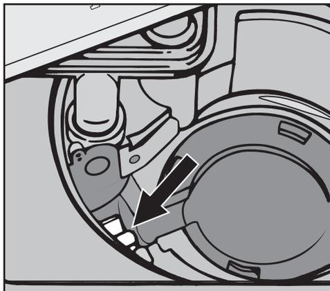
Sotto la valvola antiritorno si trova la pompa di scarico (freccia).
