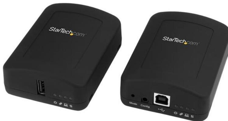
Mit diesem Single-Port-USB 2.0-Extender können Sie über Cat5e- oder Cat6-Kabel auf Ihr USB-Gerät in einer Entfernung von bis zu 100 m zugreifen und es von dort aus nutzen. Und da er wahlweise von der Lokal- oder der Remote-Einheit betrieben werden kann, können Sie Ihr USB-Gerät ganz flexibel genau dort platzieren, wo Sie es benötigen. Das ist die perfekte Lösung für die Verlängerung von USB in Lagerhallen, Fabriken, Klassen- und Konferenzräumen sowie für Anwendungen daheim oder im Büro.
