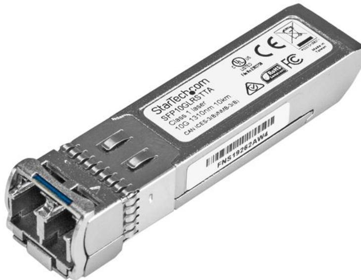
Das SFP10GLRST ist ein TAA-konformes, Cisco SFP-10G-LR-kompatibles Glasfaser-Transceiver-Modul, das speziell für die Zusammenarbeit mit Cisco™-Switches und -Routern entwickelt, programmiert und getestet wurde. Es liefert zuverlässige 10-GbE-Konnektivität über Glasfaserkabel für 10GBASE-LR-konforme Netzwerke mit einer maximalen Entfernung von bis zu 10 km.
