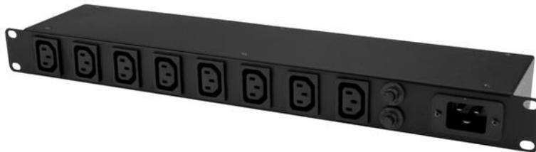
Cette unité de distribution d'alimentation montée en rack est équipée de huit sorties C13 et s'intègre dans 1U d'espace rack pour alimenter votre équipement monté en rack. Elle fournit 16 A d'alimentation à partager entre les huit sorties.
