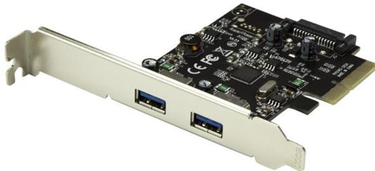
Mit dieser USB 3.1-Karte fügen Sie Ihrem Computer zwei USB Type-A-Ports über einen PCI Express-Steckplatz hinzu. Sie ermöglicht Ihnen die Erweiterung Ihres derzeitigen Systems durch Hinzufügen von zwei USB 3.1 Gen 2-Ports zu Ihrem Computer und verschafft Ihnen Zugang zu Datenübertragungsgeschwindigkeiten von bis zu 10 Gbit/s.
