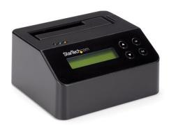
Mit diesem Festplatten-Löscher können Sie ein SATA-Solid-State-Laufwerk (SSD) oder Festplatte (HDD) löschen, ohne eine Verbindung zu einem Host-Computer herstellen zu müssen. Dieser ist kompatibel mit 2,5- und 3,5-Zoll-Festplatten und unterstützt SATA I, II und III sowie Laufwerke mit großer Kapazität, einschließlich 4Kn-Festplatten.
