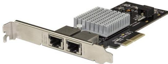
Diese Dual-Port-Netzwerkkarte bietet vielfältige und kostengünstige Netzwerkkonnektivität durch Vergrößerung der verfügbaren Netzwerkbandbreite ohne Ersetzung Ihrer bestehenden Kabelinfrastruktur. Die Netzwerkkarte, die 5 Geschwindigkeiten unterstützt, erlaubt es Ihnen, zwei 10G/NBASE-T RJ45-Ports zu Ihrem Server oder Desktop-Computer hinzuzufügen und in mehreren Geschwindigkeiten auf Ihr Netzwerk zuzugreifen: 10G, 5G, 2.5G, 1G und 100 Mbit/s.
