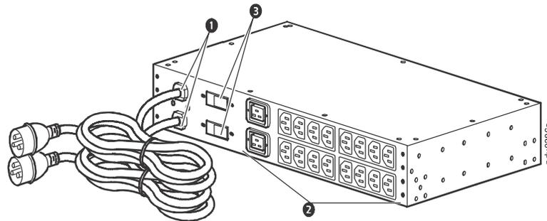
**Cordons d'alimentation:** Les deux cordons relient le commutateur de transfert automatique à deux sources d'alimentation séparées (A, B). Le commutateur puise le courant à partir de la source principale et bascule automatiquement vers la source secondaire si nécessaire. Les deux (2) cordons d'alimentation de 2,44 m sont dotés de fiches CEI-309, 32A.
