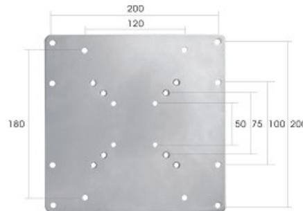
Die NewStar VESA-Adapterplatte, Modell FPMA-VESA200, ermöglicht die Aufhängung einer VESA-Halterung mit 50x50, 75x75 oder 100x100 mm Schnittstelle, mit Displays mit VESA Lochmuster 100x200, 200x200 und 120x180 mm (JVC Lochmuster). Ideal, wenn ihr Flachbildschirm andere VESA-Lochmuster an der Wand-, Schreibtisch-oder Deckenhalterung braucht.
