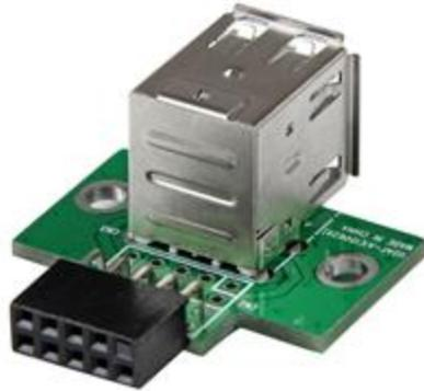
Dieser USB A-auf-USB-Mainboard-4-Pol-Header wird direkt am Mainboard-USB-Header angeschlossen und bietet zwei standardmäßige USB A-Buchsen.
