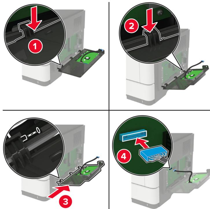
Si un disque dur d'imprimante est installé, retirez-le avant d'installer le port ISP.
