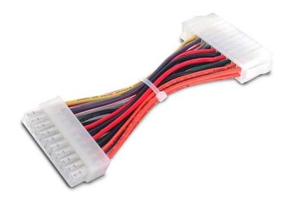
Der 20- bis 24-polige Netzteiladapter ATX2024FM ermöglicht eine kostengünstige Verbindung zwischen einem 20-poligen kompatiblen Motherboard und einem Netzteil mit 24-poligem Anschluss. Der Adapter ermöglicht die Verwendung eines neueren 24-poligen Netzteils mit einem älteren 20-poligen Motherboard.
