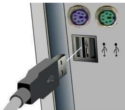
a. Diagramma di porte USB sul retro di un PC
