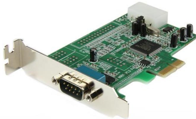
La scheda seriale PCI Express PEX1S553LP trasforma uno slot PCI Express in una connessione seriale RS-232 (DB9). La scheda è realizzata con un design a chip singolo nativo che consente di sfruttare tutte le funzionalità offerte da PCI Express (PCIe) riducendo al contempo il carico della CPU fino al 48% rispetto alle schede seriali a chip ponte convenzionali.
