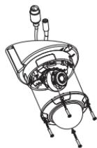
Verificare che il fermo in gomma sia nel canale cavo laterale per fissarlo.
