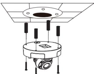
Utilisez les vis fournies pour monter la caméra au plafond.
