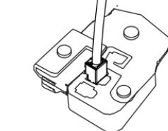
Branchez la prise RJ-45 dans le connecteur Ethernet, puis vissez le connecteur étanche dans le connecteur Ethernet en le tournant d'environ un demi-tour dans le sens horaire.
