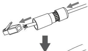
Engaste un conector RJ-45 en el extremo del cable.
