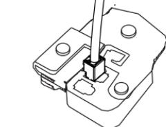
Stecken Sie den RJ-45 Stecker in den Ethernet-Steckverbinder und drehen Sie den wassererdichten Steckanschluss im Uhrzeigersinn etwa eine halbe Umdrehung auf den Ethernet-Steckverbinder.
