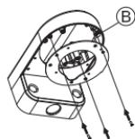
Снимите защитную крышку камеры.
