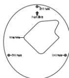
Use os parafusos fornecidos para montar o DCS-37-3 no teto usando os orifícios de montagem internos.
