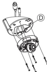
Entfernen Sie die Abdeckung und passen Sie Winkel und Drehung der Kamera nach Wunsch an, dann setzen Sie die Abdeckung wieder auf. Schrauben Sie die Kameraabdeckung wieder fest.
