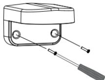
請將攝影機接頭穿過DCS-37-1背面或底部的線槽，再用包裝內附的螺絲對準標示為B的孔位來將壁掛背板鎖上。
