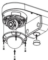
Jika Anda meletakan kabel kamera melalui dinding, letakkan penutup karet ke saluran kabel bawah untuk menutupunya.
