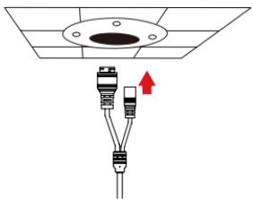
Collegare i cavi di alimentazione ed Ethernet oppure solo il cavo Ethernet se si utilizza una connessione PoE.
