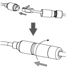
Sambungkan konektor RJ-45 ke konektor Ethernet, lalu pasang konektor kedap air ke konektor Ethernet dengan memutar searah jarum jam sekitar setengah putaran.
