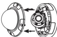
Use os parafusos fornecidos para montar a câmera na parede.
