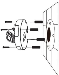
**In caso di montaggio della camera al soffitto**, usare un cacciavite a testa piatta per rimuovere il coperchio del foro di plastica dalla base, quindi guidare i cavi attraverso la base.
