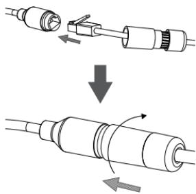
Collegare lo spinotto RJ-45 al connettore Ethernet, quindi avvitare il connettore impermeabile a quello Ethernet ruotandolo di mezzo giro in senso orario.
