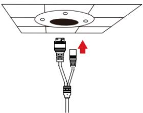
Schließen Sie das Strom- und Ethernet-Kabel oder nur das Ethernet-Kabel an, wenn Sie eine PoE-Verbindung verwenden.
