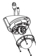
Achten Sie darauf, dass sich die Gummistopper zur Abdichtung im seitlichen Kabelkanal befinden.
