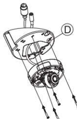
Отрегулируйте положение объектива, после чего установите защитную крышку. Закрепите защитную крышку при помощи винтов.
