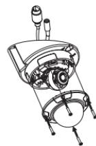
請確認橡膠墊已封住側邊的線槽。
