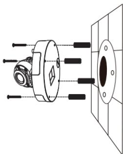
若您要將攝影機安裝在天花板，請用一字螺絲起子將底座的塑膠孔蓋取下，再將線材穿過底部。
