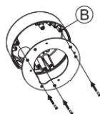
Снимите защитную крышку камеры.
