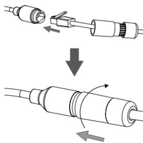
Соедините коннектор с разъемом RJ-45. Закрутите водонепроницаемый коннектор, повернув его приблизительно на пол-оборота по часовой стрелке.
