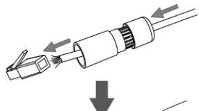
Fissare un connettore RJ-45 sull'estremità del cavo.
