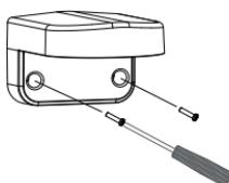
Guidare i connettori della videocamera attraverso il canale cavo posteriore o inferiore in DCS-37-1. Quindi, avvitare la piastra di montaggio sulla staffa utilizzando i fori di montaggio contrassegnati con **B**.
