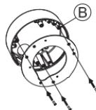
Entfernen Sie die Abdeckung der Kamera.
