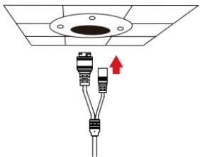
Conecte la alimentación y los cables Ethernet o solo el cable Ethernet si está utilizando una conexión PoE.
