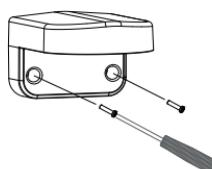
Passez les connecteurs de la caméra à travers le passage arrière ou latéral des câbles de la DCS-37-1. Puis vissez la plaque de montage sur le support à l'aide du jeu d'orifices de montage marqués **B**.
