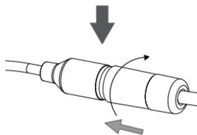
Aperte a parte traseira do conector impermeável no sentido horário até existir uma vedação apertada em torno do cabo Ethernet.
