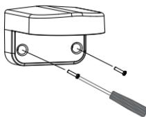
Guíe los conectores de la cámara por el canal del cable posterior o inferior en el DCS-37-1. A continuación, atornille la placa de montaje al soporte utilizando el conjunto de orificios de montaje marcados como **B**.
