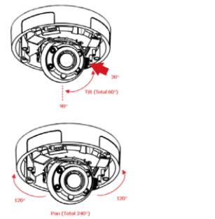
請將鏡頭旁的調整螺絲轉鬆，調整鏡頭至您想要的角度後再將螺絲轉緊。攝影機可調整的傾斜角度為30° 到90° 。您也可以在-120° 到120° 範圍內以順時針或逆時針方向旋轉來調整角度。
