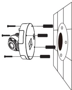
**Se você estiver montando a câmera no teto**, use uma chave de fenda de cabeça lisa para remover a tampa de furo de plástico do fundo da base e guie os cabos pela parte inferior.
