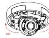
Utilizzare le viti fornite per montare la camera al soffitto.
