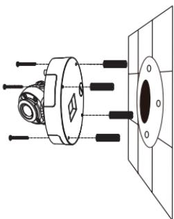
**Jika Anda memasang kamera di atap**, gunakan obeng pipih untuk melepaskan penutup lubang plastik dari dasar alas, lalu pandu kabel melalui bagian bawah.
