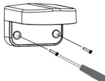
Führen Sie die Kameraanschlüsse durch den hinteren oder unteren Kabelkanal der DCS-37-1. Schrauben Sie dann die Montageplatte mithilfe der mit **B** markierten Montageöffnungen an der Halterung fest.
