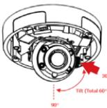
Wenn Sie mit dem Anpassen des Kamerawinkels fertig sind, bringen Sie die innere Verkleidung wieder an.
