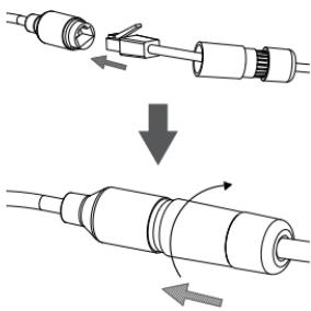
Vissez la partie arrière du connecteur étanche dans le sens horaire jusqu'à former un joint étanche autour du câble Ethernet.
