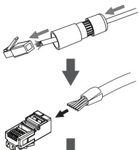
請用壓線鉗將RJ-45接頭安裝在網路線末端。
