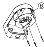
Entfernen Sie die Abdeckung der Kamera.
