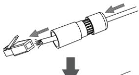
Klemmen Sie dann einen RJ-45-Stecker mit einer Crimpzange auf das Kabelende.
