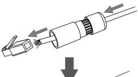
Memasang konektor RJ-45 di ujung kabel.
