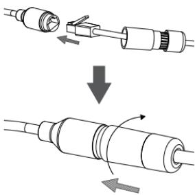
請將RJ-45接頭接至乙太網路接頭，再將防水接頭以順時針方向轉半圈方式來轉進乙太網路接頭。
