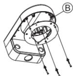
Retire la cubierta de la cámara.
