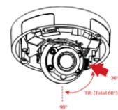
Al termine della regolazione dell'angolo della camera, riposizionare il coperchio interno.
