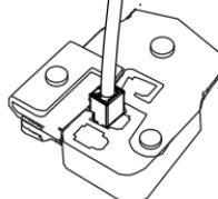
Conecte o plugue RJ-45 no cabo de Ethernet e, em seguida, parafuse o conector impermeável ao conector Ethernet girando-o no sentido horário por cerca de meio turno.
