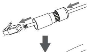
Coloque um conector RJ-45 na extremidade do cabo.
